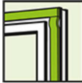
De banden mogen niet om de hoek van het kozijn geleid worden
