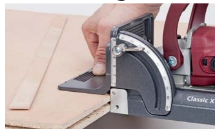
Doorlopende groeven frezen voor tand- en groefverbindingen, standaard HW-groeffrees 4 mm
