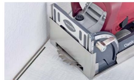
Snijden van schaduwvoegen voor houten plafonds en parket- of laminaatvloeren, glijdschoen en HW-zaagblad
