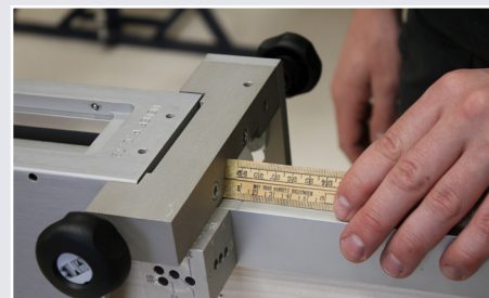
Afb. 13 Verplaatsing U-cassette met 12 mm
