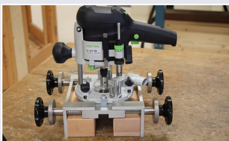
Afb. 17 106500 Freesgeleider t.b.v. voorplaat
