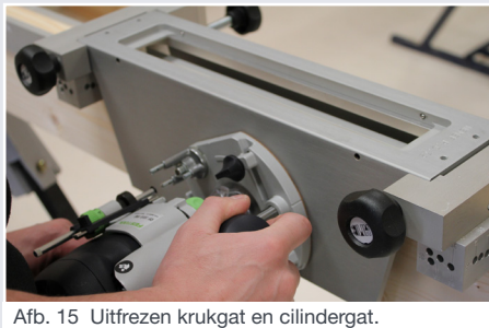
Afb. 15 Uittrezen krukgat en cilindergat.
